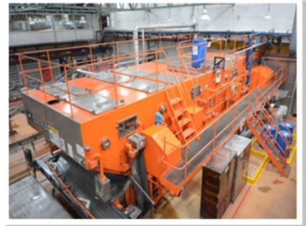
โครงการลดอุณหภูมิการล้างขวดเครื่อง Washer Line 4 จาก 70 - 80 องศาเซลเซียส เป็น 60 - 70 องศาเซลเซียส สามารถลดการใช้น้ำมันเตา 9,907 ลิตร /ปี
